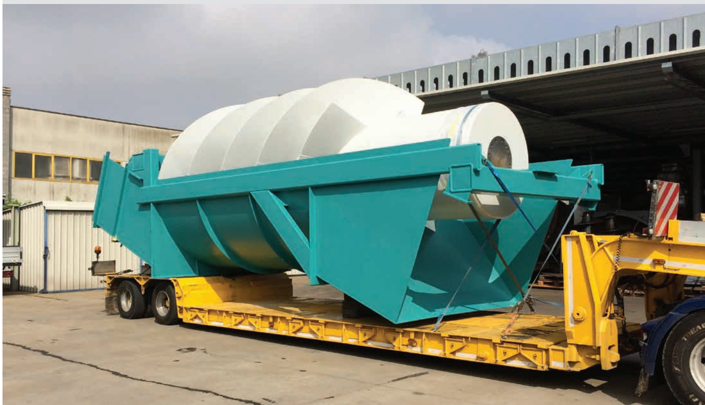
Elica completa di trugolo per centrale idroelettrica. Screw and trough for hydroelectric power plant.
