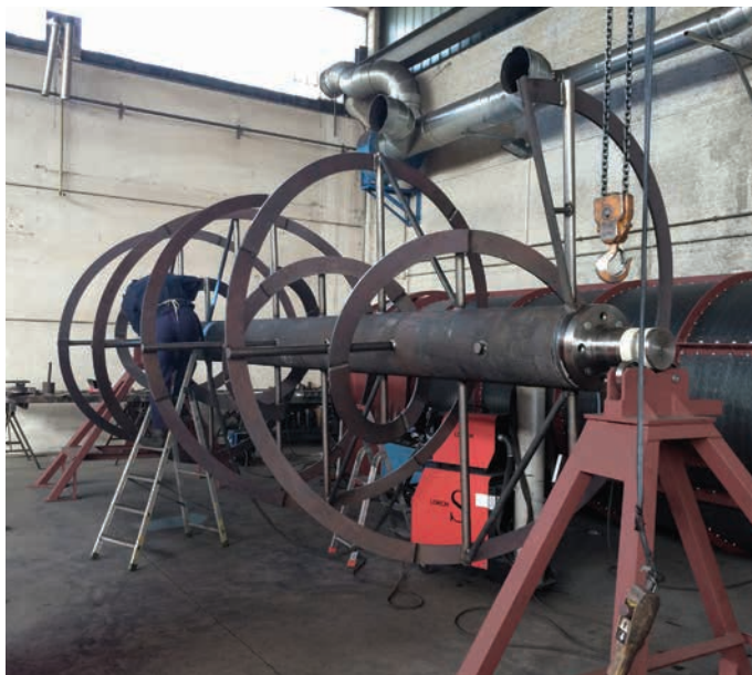
Aspo per miscelatore orizzontale. Reel for horizontal mixer wagon.
