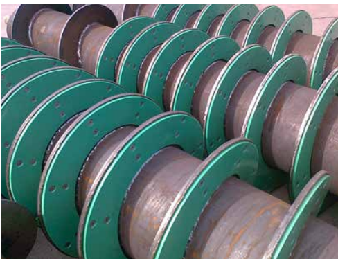
Rotori di grosse dimensioni: coclea a passo variabile per estrazione. dotata di inserti in polizene.
