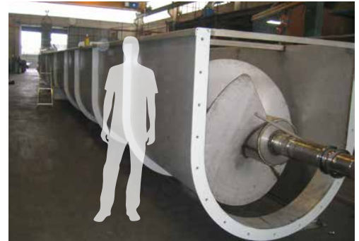
Coclea in acciaio aisi 304 diam. 1600 per trasporto zucchero.
