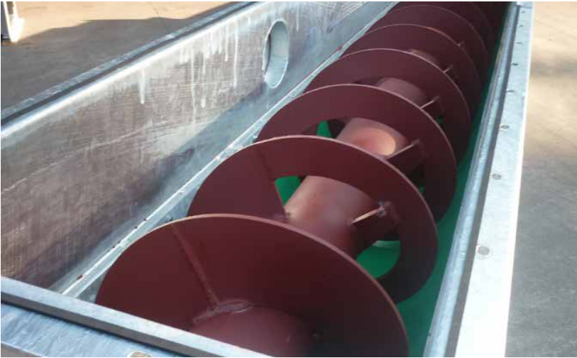
Rotori di grosse dimensioni: coclea a passo variabile per estrazione. dotata di inserti in polizene.
