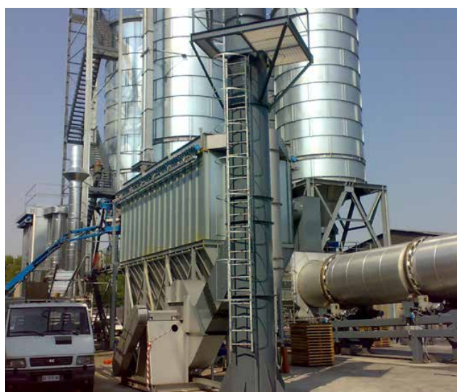
Esempio di filtro da 600 maniche con cestelli smontabili dall'alto.
