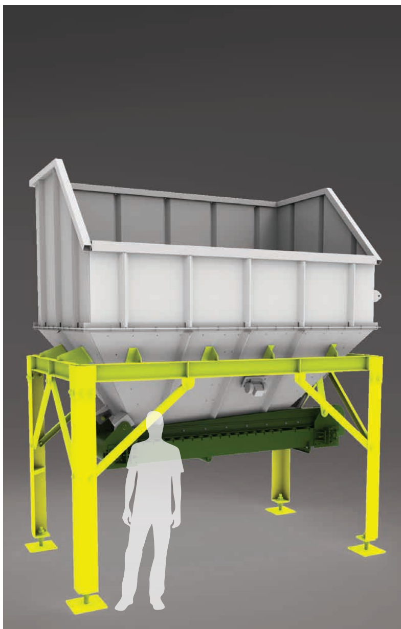
Tramoggia con nastro estrattore da 18 metri cubi.
